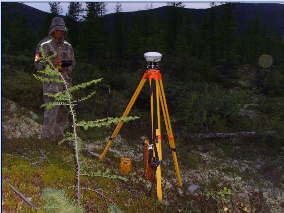
Создание планово-высотного обоснования
