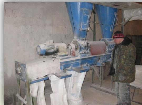
**Экструдирование концентрированных кормов**
