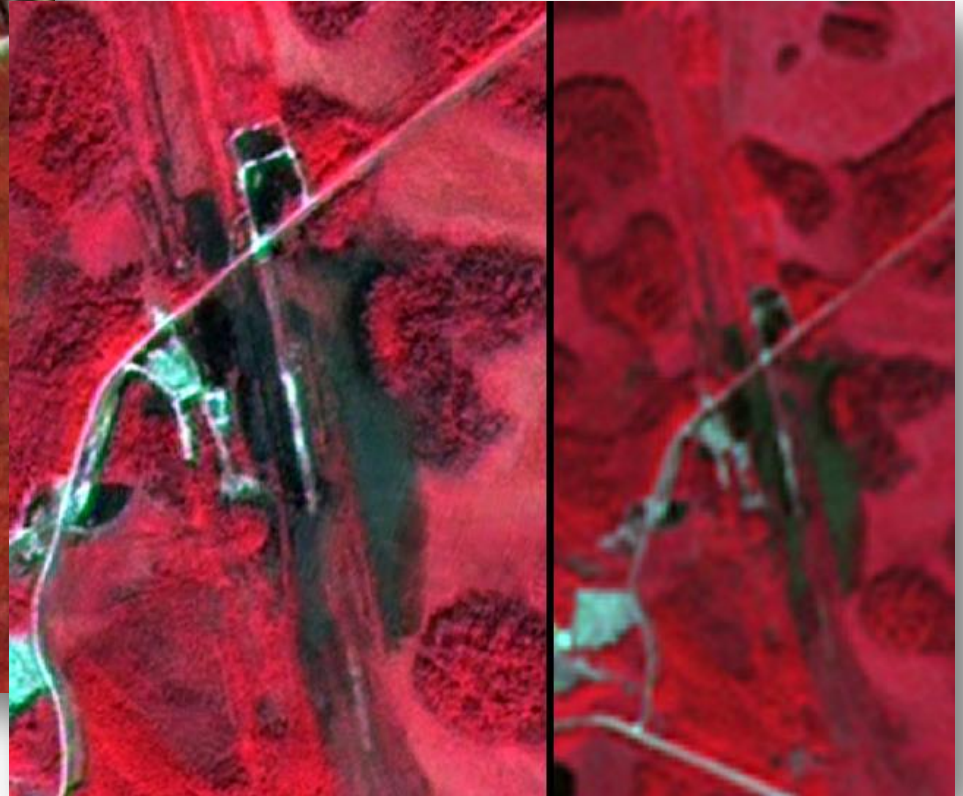
Возможность дешифрирования «пятен» вдоль трубопроводов по улучшенным (2,5 метра) и стандартным (10 метров) снимкам ALOS
