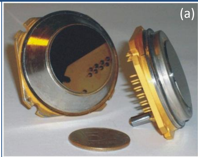
Общий вид микроболومترической головки (а) и тепловизионной камеры (б)
