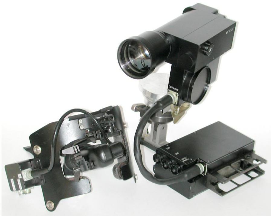
Ночные прицелы "Аргус-23" и "Аргус-АИ" для стрелкового оружия
